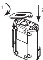
Bringen Sie die Abdeckung „BATTERY“ 1 ans Gerät an, indem Sie sie vorne in das Gehäuse 2 einhaken und den hinteren Teil ganz nach unten drücken, bis er einrastet.
