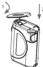
Applicate all'apparecchio il coperchio “**AIR FILTER**” 1 agganciandolo nella parte anteriore della sede e 2 premendo a fondo la parte posteriore fino ad ottenere uno scatto per l'incastro.
