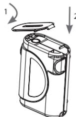
Sätt fast "AIR FILTER"-locket 1 på enheten genom att haka fast det i framsidan av höljet och 2 trycka ned baksidan helt tills det klickar på plats.
