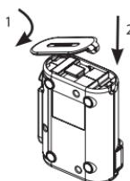
Bevestig het "BATTERY"-deksel 1 aan het apparaat door het in de voorkant van de behuizing 2 te haken en de achterkant volledig naar beneden te drukken tot het erop klikt.
