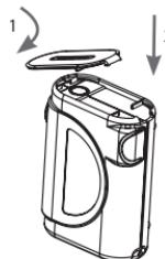
Bevestig het "AIR FILTER"-deksel 1 aan het apparaat door het aan de voorkant van de behuizing te haken en 2 door de achterkant naar beneden te drukken tot het vastklikt.
