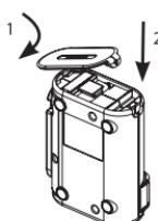
Установите крышку «BATTERY» на прибор, зацепив ее за переднюю часть гнезда (1) и нажимая на заднюю часть до упора, пока она не встанет на место со щелчком(2).
