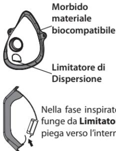
Le mascherine **SoftTouch** hanno il bordo esterno realizzato in **morbido materiale biocompatibile** che garantisce un'ottima aderenza al viso, e sono inoltre dotate dell'**innovativo Limitatore di Dispersione**. Questi caratteristici elementi che ci contraddistinguono, consentono una maggiore sedimentazione del farmaco nel paziente, ed anche in questo caso ne **limita la dispersione**.
