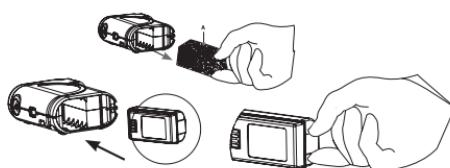
Verwijder de spons/demper uit het batterijvak voordat u de batterij plaatst. Plaats de originele Flaem-batterij, die u bij uw dealer kunt krijgen.
