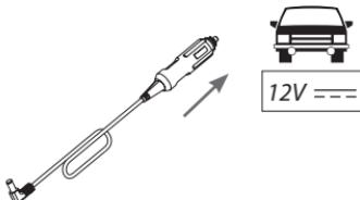
Sätt i kabelns kontakt (A9) i bilens/husbilens/båtens cigarettändaruttag 12V DC. Kontrollera i fordonets instruktionsbok att den levererade spänningen är 12V DC.
