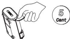
Um die Abdeckung „BATTERY“ zu entfernen, heben Sie sie mit einer kleinen Münze geeigneter Größe ab, indem Sie sie in den hinteren Schlitz stecken.
