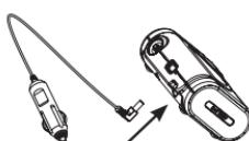
Wtyczkę „L” kabla do zapalniczki należy włożyć w gniazdko prądu stałego urządzenia.
