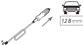
Вставьте разъем кабеля (A9) в гнездо прикуривателя постоянного тока 12 В автомобиля/кампера / лодки. Проверьте в руководстве по эксплуатации транспортного средства, что напряжение питания составляет 12 В постоянного тока.
