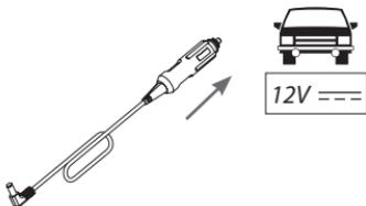
Stecken Sie den Stecker des Kabels (A9) in die Zigarettenanzünder-Buchse 12V DC des Autos/ Wohnmobils/Bootes. Vergewissern Sie sich in der Betriebsanleitung des Geräts, dass die Versorgungsspannung 12 V DC beträgt.
