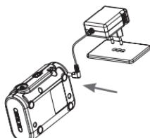
Sätt i nätaggregatkabelns "L"-kontakt i enhetens DC-pluggkontakt.
