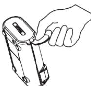
Um die Abdeckung „**LUFTFILTER**“ zu entfernen, hebeln Sie sie mit einer kleinen Münze geeigneter Größe auf, indem Sie sie in den hinteren Schlitz einführen.
