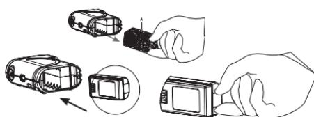
Bevor Sie die Batterie einlegen, entfernen Sie den Schwamm/Schalldämpfer aus dem Batteriefach. Legen Sie die Original-Flämm-Batterie ein, die Sie bei Ihrem Händler erhalten können.
