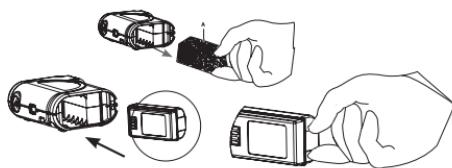
Prima di inserire la batteria, estrarre la spugna/ silenziatore dal vano porta-batteria. Inserite la batteria originale Flaem che potete reperire presso il vostro rivenditore di fiducia. **SOSTITUZIONE E FINE VITA**
