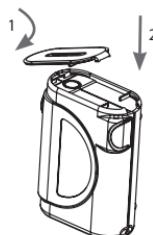
Włożyć klapkę „AIR FILTER” 1, zaczepiając ją w przedniej części wnęki 2, naciskając do końca tylną część, aby usłyszeć odgłos zamknięcia.
