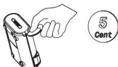
Aby usunąć klapkę „BATTERY”, należy podważyć ją małą odpowiednią monetą, wkładając ją w tylną szczelinę.
