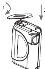
Установите крышку «AIR FILTER» на прибор, зацепив ее за переднюю часть гнезда (1) и нажимая на заднюю часть до упора, пока она не встанет на место со щелчком (2).
