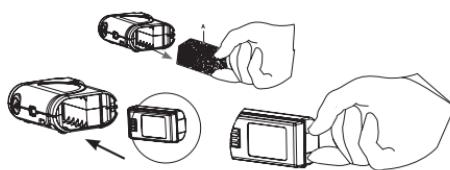
Innan du sätter i batteriet, ta bort svamphen/ dämparen från batterifacket. Sätt i originalbatteriet från Flaem, som du kan köpa hos din betrodda återförsäljare.
