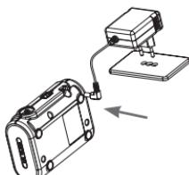
Stecken Sie den „L“-Stecker des Netzteilkabels in den Gleichstrombuchse des Geräts ein.
