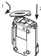
Sätt fast "BATTERY"-locket 1 på enheten genom att haka fast det i framsidan av höljet 2 och trycka ned baksidan helt tills det klickar på plats.
