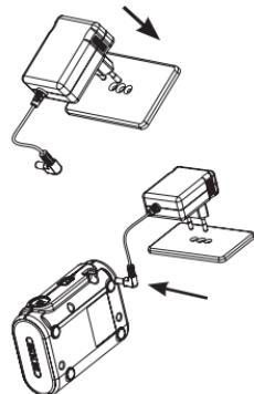
Stecken Sie das Netzteil in die Netzsteckdose und achten Sie darauf, dass es sich leicht vom Stromnetz trennen lässt.
