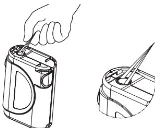
Ziehen Sie den verschmutzten Filter mit einer handelsüblichen Pinzette heraus und setzen Sie den neuen ein, indem Sie ihn ganz in seinen Sitz einsetzen.
