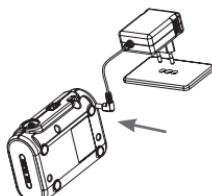
Steek de "L"-vormige stekker van de voedingskabel in de DC-stekker van het apparaat.
