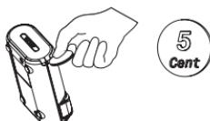
Om het deksel "BATTERY" te verwijderen, wrik u het los met een klein muntstuk van geschikte grootte door het in de gleuf aan de achterkant te steken.
