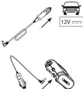
Steek de stekker van de kabel in de 12V DC sigarettenaanstekerplug van de auto/camper/boot. Controleer in de handleiding van het voertuig of de geleverde spanning 12Vdc is.
