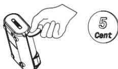
För att ta bort "BATTERY"-locket, bänd loss den med ett litet mynt av lämplig storlek genom att föra in det i det bakre skåran.
