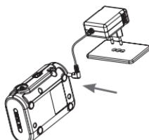
Вставьте штекер «L» кабеля блока питания в разъем постоянного тока прибора.
