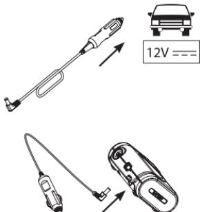
Вставьте штекер кабеля в гнездо прикуривателя постоянного тока 12 В автомобиля /кампера / лодки. Проверьте в руководстве по эксплуатации транспортного средства, что напряжение питания составляет 12 В пост. тока.
