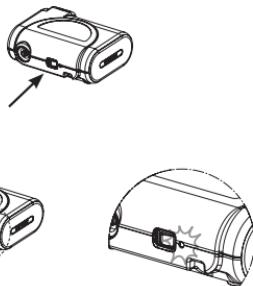
Stellen Sie sicher, dass der Schalter AUSGESCHALTET ist und sich in der Position (0) befindet.
