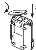
Włożyć klapkę „BATTERY” 1, zaczepiając ją w przedniej części wnęki 2, naciskając do końca tylną część, aby usłyszeć odgłos zamknięcia.
