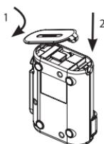
Fixez le couvercle "BATTERIE" 1 à l'appareil en l'accrochant à l'avant du boîtier 2 et en appuyant à fond sur l'arrière jusqu'à ce que le couvercle "BATTERIE" s'enclenche. un seul clic pour l'emboîtement.
