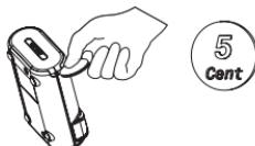
Чтобы снять крышку батареи «BATTERY», подденьте ее мелкой монетой подходящего размера, вставив ее в задний паз.
