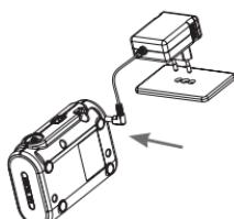
Wtyczkę „L” kabla zasilającego należy włożyć w gniazdko prądu stałego urządzenia.
