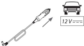
Wtyczkę kabla (A9) należy włożyć w odpowiednie gniazdko zapalniczki 12 V DC w samochodzie/pojeździe kempingowym/jachcie. Sprawdzić w instrukcji obsługi pojazdu/jachtu, czy dostarczane napięcie wynosi 12 V DC.
