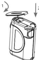
Fixez le couvercle du "FILTRE D'AIR" 1 à l'appareil en l'accrochant à l'avant du boîtier et 2 en appuyant sur l'arrière jusqu'à ce qu'il s'enclenche.
