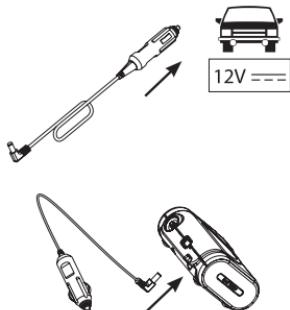
Stecken Sie den Stecker des Kabels in die Zigarettenanzünder-Buchse 12V DC des Autos/Wohnmobil/Bootes. Vergewissern Sie sich in der Bedienungsanleitung des Geräts, dass die Versorgungsspannung 12Vdc beträgt.
