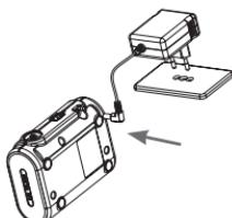
Inserire la spina a "L" del cavo dell'alimentatore nella presa DC plug dell'apparecchio.
