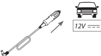
Inserire la spina del cavo (A9) nell'apposita presa per accendisigari 12V DC dell'auto/camper/barca. Verificare sul Manuale d'Uso del mezzo che la tensione fornita sia 12V DC.
