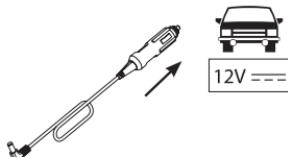
Sätt i kabelns kontakt i bilens/husbilens/båtens cigarettändaruttag 12V DC. Kontrollera i fordonets instruktionsbok att den levererade spänningen är 12Vdc.
