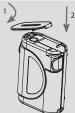
Applicate all'apparecchio il coperchio "AIR FILTER" 1 agganciandolo nella parte anteriore della sede e 2 premendo a fondo la parte posteriore fino ad ottenere uno scatto per l'incastro.
