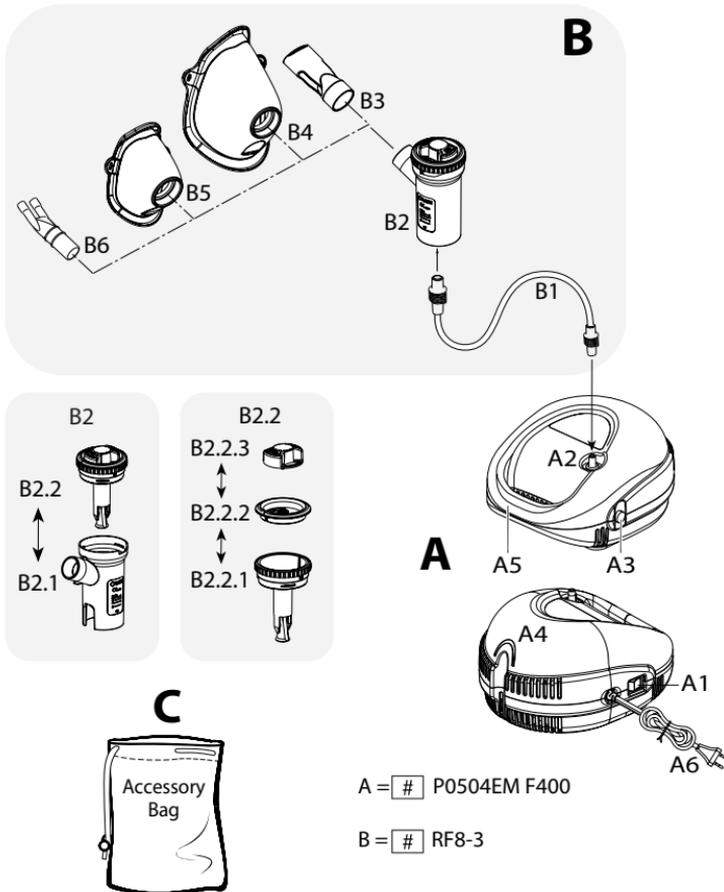
Schema di collegamento - Connection diagram - Anschlusschema - Schéma de branchement - Verbindungsschema - Esquema de conexión - Διαγράμμα σύνδεσης - Schemat połączeń - مخطط التوصيل
