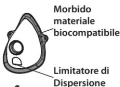
Le mascherine **SoftTouch** hanno il bordo esterno realizzato in **morbido materiale biocompatibile** che garantisce un'ottima aderenza al viso, e sono inoltre dotate dell'**innovativo Limitatore di Dispersione**. Questi caratteristici elementi che ci contraddistinguono, consentono una maggiore sedimentazione del farmaco nel paziente, ed anche in questo caso **ne limita la dispersione**.
