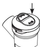
Per rendere più efficace la terapia inalatoria, premete con il dito sull'iscrizione MIN del selettore di velocità (B2.4). In questa posizione, il selettore agisce come una valvola e permette di nebulizzare la quantità ottimale di farmaco fino alle basse vie respiratorie, riducendone la dispersione nell'ambiente.
