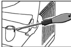
**Aby wymienić filtr, wyciągnij go w sposób pokazany na rysunku.**
