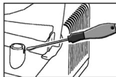
**Για να αντικαταστήσετε το φίλτρο, τραβήξτε το όπως φαίνεται στο σχήμα.**
