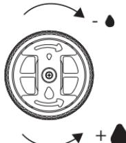
Pour utiliser l'ampoule sans sélecteur, tenir fermement le corps de l'ampoule et, de l'autre main, tourner le régulateur de granulométrie (B2.4) dans le sens des aiguilles d'une montre jusqu'à ce qu'il ne soit éjecté de la partie supérieure (B2.3).
