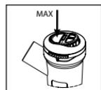
Per rendere più efficace la terapia inalatoria posizionate il selettore di velocità con valvola (C1.4) premendo con un dito sul lato opposto alla scritta Max, in questo caso otterrete un'acquisizione ottimale del farmaco riducendo al minimo la dispersione dello stesso nell'ambiente circostante, grazie al sistema valvolare di cui l'ampolla, il boccaglio, la mascherina sono dotate.
