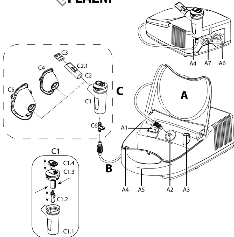
Schema di collegamento - Assembly diagram - Schéma de montage - Verbindungsschema
